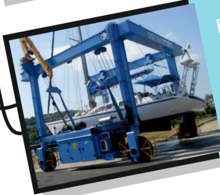
Élévateur à bateau d'une capacité jusqu'à 50 tonnes
