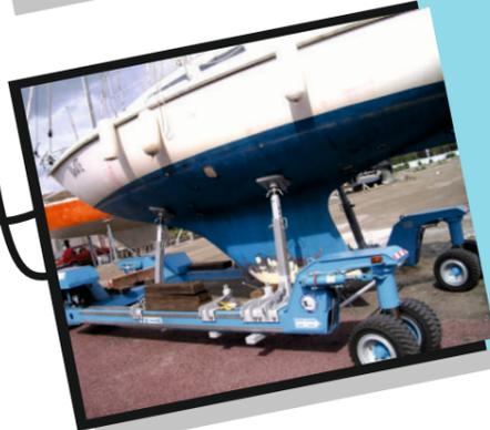
Ber automoteur d'une capacité jusqu'à 20 tonnes
